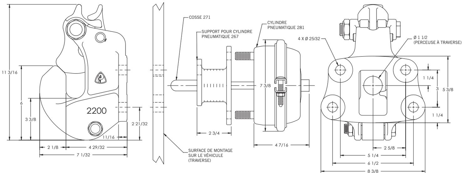
La longueur de la tige de culbuteur est de 3 5/8 po (92 mm) plus l'épaisseur de la structure de montage pour les installations standard comme montré.
